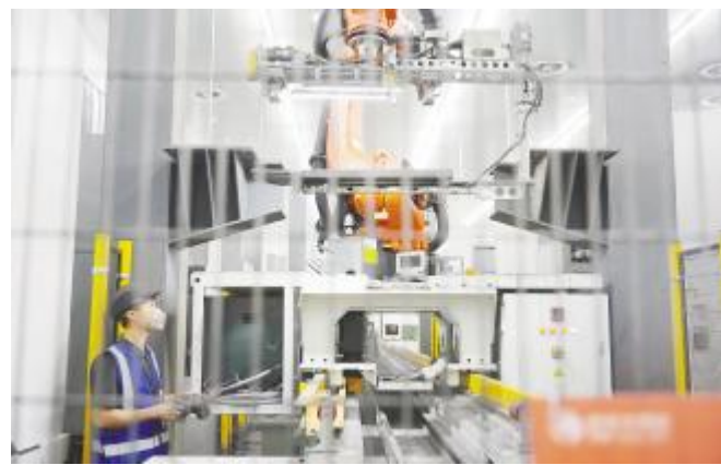
杨明星专注调整硅片托盘夹角取数
